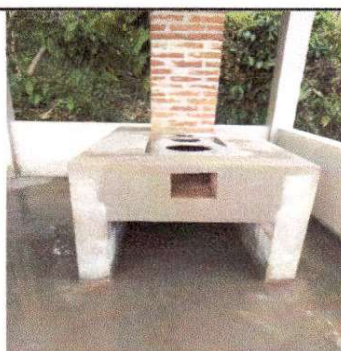
Foto 12: Sustitución de estufa rural (Completa, incluye chimenea y plancha de metal)
